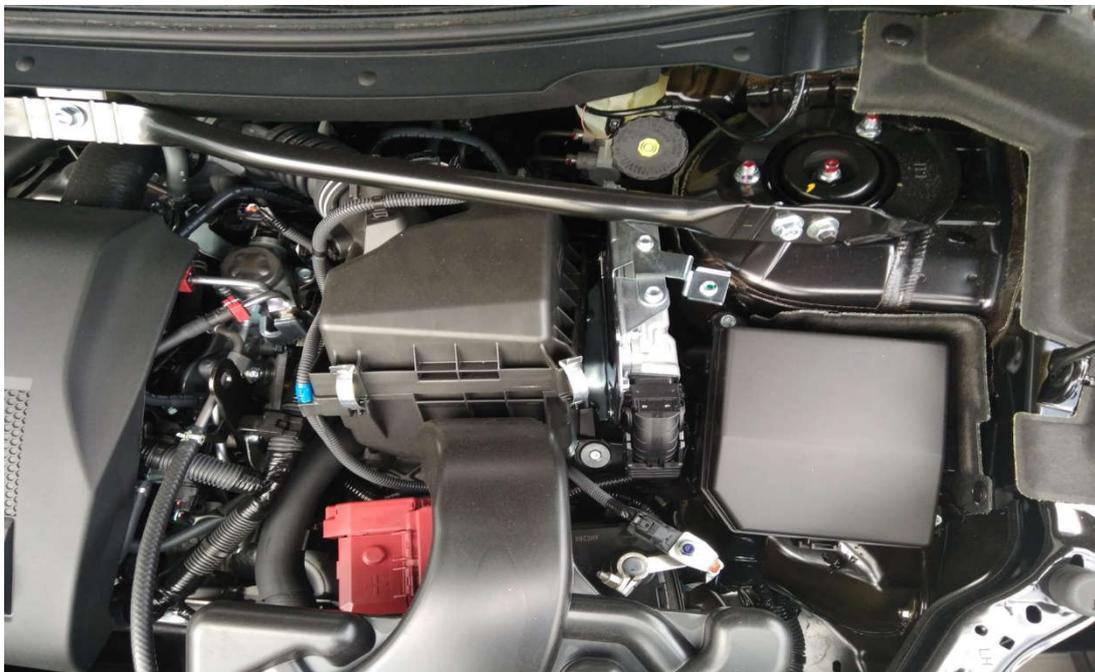
3. Установить защиту на блок управления двигателем.
